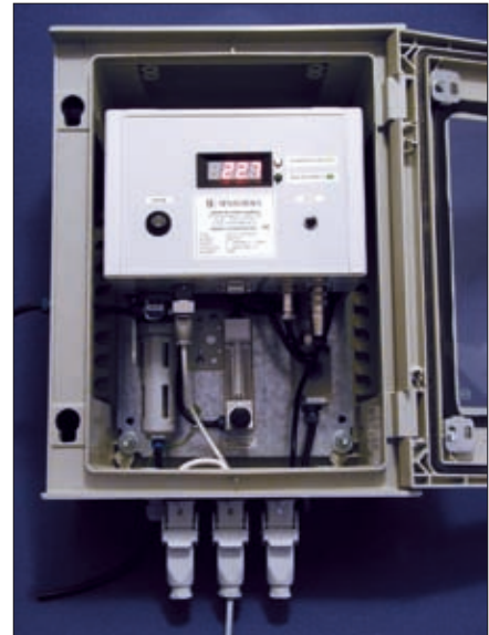
Obr. 4. Měřicí skříň se zařízením pro měření vlhkosti spalin
