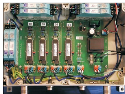
Obr. 4. Pohled na elektroniku analyzátoru vlhkosti System 4215 se Zenerovými bariérami MTL, chránícími vstupy aktivních měřicích sond vlhkosti a teploty plynů
