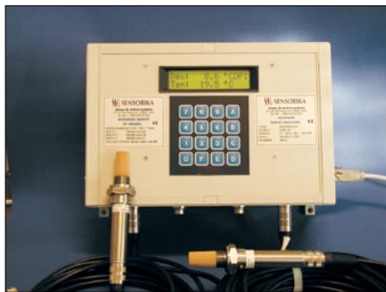
Obr. 3. Čtyřvstupový analyzátor System 4215 pro měření vlhkosti a teploty výbušných plynů s tlakovými měřicími sondami vlhkosti a teploty HTP-7512
