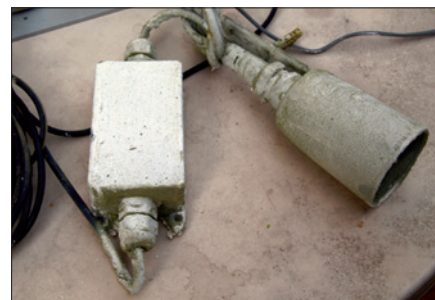
Obr. 18. Ochrana měřicí sondy vlhkosti a teploty proti rozprášené barvě v prostoru lakovny
