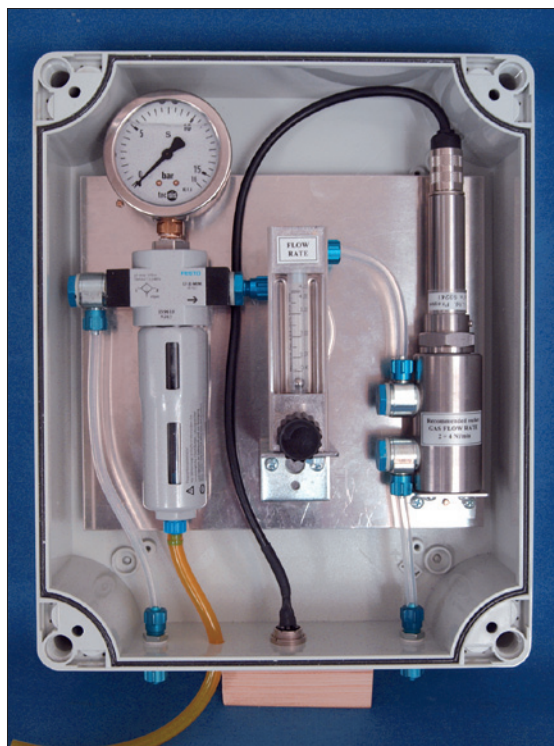
Obr. 20. Příklad měřicího kabinetu pro připojení k hygrometru – uspořádání k měření atmosférického rosného bodu
