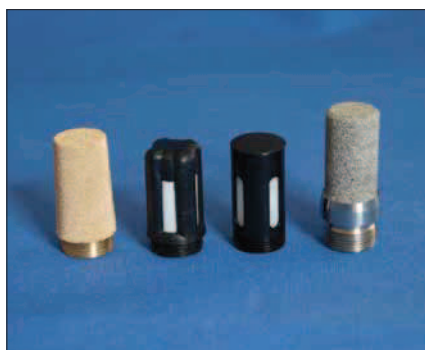
Obr. 15. Krytky senzorů měřících sond vlhkosti a teploty (zleva doprava: krytka ze sintrovaného bronzu, krytka polyamidová s polyesterovou sítkou, krytka duralová s polyesterovou sítkou, krytka sintrovaná z koroziivzdorné oceli)
