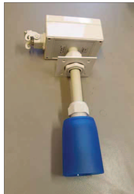
Obr. 12. Převodník vlhkosti a teploty řady SDKA 123 s upevňovací přírubou a antikondenzační krytkou
